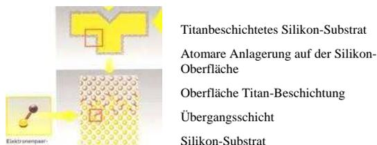
Vereinfachte schematische Darstellung der Titanisierung einer Silikonoberfläche. Der neuartige Verbundwerkstoff, das titanisierte Silikon, weist also die natürliche Flexibilität des Silikonimplantates auf, gleichzeitig aber die exzellente Gewebeverträglichkeit des Titans, ohne dass sich an der Handhabung etwas ändert. Während die Titanisierung bei Mamma-Implantaten bereits CE-zertifiziert ist, steht dies für Gesichtsimplantate derzeit noch aus, es sind weitere Tierversuche vorgesehen.
