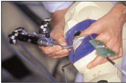
Abb. 6: Umsetzung der Planung am Phantom (Kunststoffmodell). An der Schiene ist die Leuchtdiodenplatte zur Referenzierung und späteren Registrierung der Patientenbewegungen angebracht, mit dem Winkelstück sind zwei weitere Leuchtdiodensysteme zur Registrierung der Pointerposition fest verbunden
