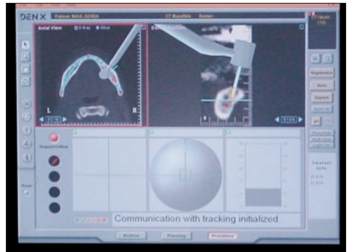
Abb. 11: Das Navigationssystem führt den Bohrvorgang des Chirurgen: Das Fadenkreuz links unten markiert den geplanten Implantationsort, die Kugeldarstellung in der Mitte die Achsenrichtung und die Grafik rechts die Bohrtiefe. Grüne Darstellung signalisiert Übereinstimmung mit der Planung. Rechts oben ist der Bohrvorgang im Schnittbild dargestellt, dieses kann durch Drehung dreidimensional betrachtet werden
